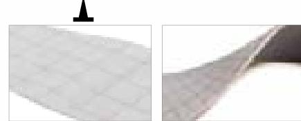
Suoletta antiperforazione a **passaggio zero** realizzata con strati sovrapposti di tessuti speciali. L'utilizzo di questi materiali garantisce un'elevata resistenza oltreché leggerezza e flessibilità. Questa suoletta ha il vantaggio di coprire l'intera superficie del sottopiede, garantendo così un'assoluta protezione a tutto il piede. K-SOLE è una suoletta non metallica, quindi non viene rilevata da metal detector.
